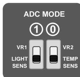
이제 코드를 업로드 합니다. 그리고 시리얼 모니터를 켵니다. 그러면 값이 대략적으로 470 ~ 500 정도로 나올 것입니다. 이것은 현재 실험하고 있는 장소의 밝기에 따라서 많은 편차가 있으니 470 ~ 500 사이가 안 나온다고 해서 코딩킷이 잘 못 됐는지, 망가졌는지 하지는 마세요. 이제 밝기 센서를 손으로 가려 보십시오. 그러면 값이 내려갈 것입니다. 손전등이나 휴대폰의 플래시를 이용하여 더 밝게 해 보십시오. 그러면 값이 올라갈 것입니다. 다음은 손으로 가려 어둡게 했을 때의 값의 변화 입니다.
