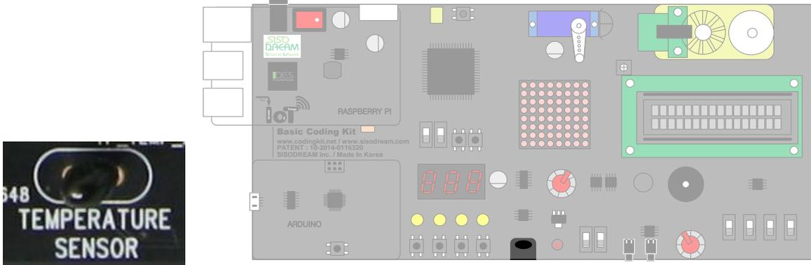
온도 센서는 온도를 측정하여 전기 신호로 바꾸어 주는 역할을 합니다. 코딩은 밝기 센서와 비슷합니다.
