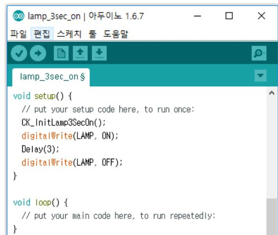
붉은색 부분이 위에서 얘기한 작업 지시서의 내용입니다. 그 이외의 부분들은 컴퓨터 언어의 문법을 맞추어 주기 위한 부분입니다. "CK\_InitLamp3SecOn();" 은 미리 작성한 부분으로 이 코드를 실행시키기 전에 추가할 것입니다. (LAMP, ON) 앞에 있는 digitalWrite 라는 것은 LAMP 에 ON 이라는 디지털 신호를 쓰라는 것으로 나중에 좀 더 살펴 보겠습니다.
