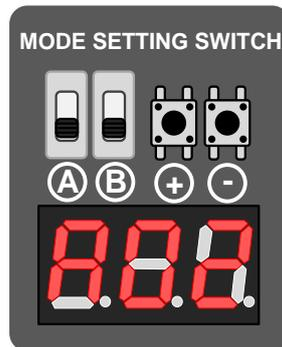
세븐세그먼트는 이름처럼 숫자나 문자를 7개의 LED 로 표현합니다. 세븐세그먼트에서는 LED 보다는 세그먼트라는 말이 더 어울립니다. 각각의 세그먼트는 A 에서 G 까지 7 개의 문자로 이름을 붙입니다. 그리고 여기에 점을 하나 더 추가합니다. 이것은 소수점 이라는 뜻으로 DP(Decimal Point)로 표시합니다.
