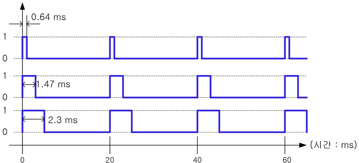
위의 그림은 듀티비보다는 시간을 중심으로 그린 것입니다. 보통 서보 모터의 설명이 이렇게 되어 있어서 여기서도 시간으로 설명 드렸습니다. 즉, PWM 신호의 주기 20 ms 중 1 인 구간이 0.64 ms, 1.47 ms, 2.3 ms 이렇게 그린 것입니다. 각각은 서보혼을 0 도, 90 도, 180 도로 돌립니다. 그러면 digitalWrite() 함수를 이용하여 PWM 신호를 만들어 서보 모터를 동작시켜 보겠습니다. 먼저 서보 모터에 연결된 핀과 PWM 의 시간을 정의 합니다.
