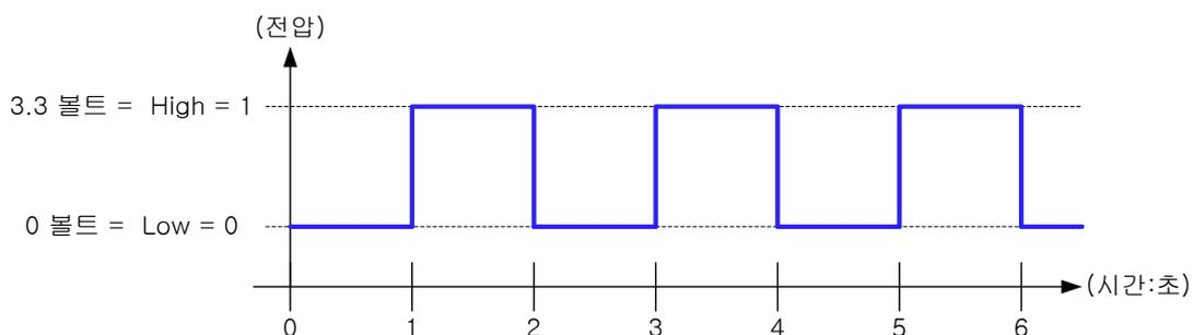
전기 신호는 보통 위의 그림과 같이 표시를 합니다. 그리고 이것을 전기 신호의 파형(Wave)이라고 합니다.
