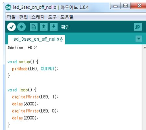
몇 가지 특이 점을 살펴 보면 LED 가 2번 핀이라는 의미로 "#define LED 2" 라고 했습니다. 그리고 또 전에는 Delay(3), Delay(2) 하던 것을 delay(3000), delay(2000)으로 사용하였습니다. 이것은 Delay 는 괄호 안의 수가 1 초 단위이고 delay 는 괄호 안 수의 단위가 1000 분의 1 초이기 때문입니다. 그래서 delay(3000) 과 Delay(3) 은 똑같이 3 초의 시간을 기다리는 것입니다.
