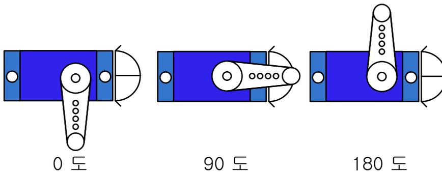
서보 모터에 입력되는 PWM 신호의 주기는 20 ms 이고 PWM 신호 중 1 인 구간이 0.64 ms 에서 2.3 ms 범위 내에서 움직입니다. 여기서 ms 는 밀리세크(Mili-second)의 약자이고 1000 분의 1 초입니다. 즉, 1ms 는 0.001 초이고 20ms 는 0.02 초 입니다. 여기서 20 ms 중 0.64 ms 가 1 이면 듀티비는 3.2% 입니다. 2.3 ms 가 1 이면 듀티비는 11.5% 입니다. 이러한 듀티비에 따라서 서보혼이 어떤 각도로 돌아 갑니다. 여기서 서보 모터에 입력되는 PWM 신호의 1 인 구간의 시간이 0.64 ms 이면 0 도이고 2.3 ms 이면 180 도 입니다. 서보 모터는 이렇게 PWM 신호의 1 인 구간의 값에 따라서 0 도 ~ 180 도까지 변합니다. 그러면
