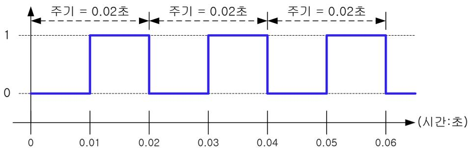
이 그림에서는 정확한 전압 값을 쓰지 않고 코딩할 때 사용하는 0 과 1 을 썼습니다. 위와 같이 어떤 **고정된 시간 안에서** 반복적으로 0 과 1 사이를 움직이는 신호를 PWM(Pulse Width Modulation)이라고 합니다. 위 그림에서 고정된 시간은 0.02 초 입니다. 이렇게 정해진 시간을 주기라고 합니다. PWM 신호는 주기 안에서 1 인 구간의 길이와 0 인 구간의 길이를 다르게 하여 어떤 의미 있는 신호를 만들어 냅니다. 다음과 같은 파형들을 볼까요?
