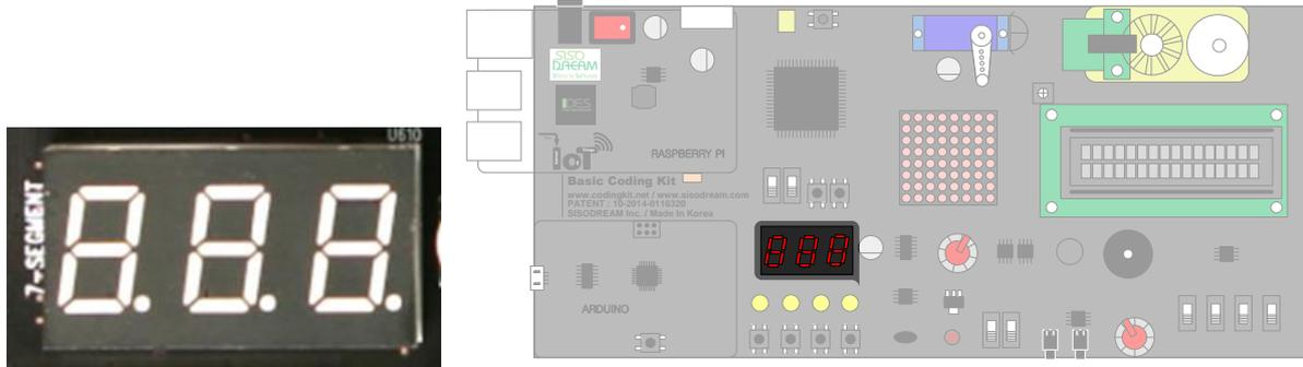
세븐세그먼트의 스위칭 ID 는 A02 입니다. 그리고 세븐세그먼트는 스위칭 ID 표시로도 사용되는 관계로 스위치와 버튼을 스위칭 ID A02 에 맞춘 다음 + 나 - 버튼을 오래 눌러 설정을 완료하면 세븐세그먼트는 꺼지거나 이전에 아두이노에 있던 코드가 수행이 될 것입니다. 그래서 조금 이상하게 동작할 수도 있습니다. 놀라지 마시고 그냥 코딩하고 업로드하여 사용하시면 됩니다.
