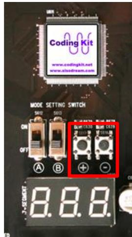
이 연결 번호와 아두이노 표시를 코딩킷에서는 스위칭 ID 라고 합니다. 더 자세한 사항은 “코딩킷 소개” 편을 참고 바랍니다. 이 스위칭 ID는 A00, A01, A02, ... 으로 표시가 됩니다. 이것은 세븐세그먼트에 표시되는 것과 동일합니다. 이제 여러분이 + 혹은 - 버튼을 1~2 초간 계속 누르고 있으면 세븐세그먼트의 깜박임이 멈추고 연결이 이루어집니다. 스위칭 시스템 설정이 완료된 것입니다.
