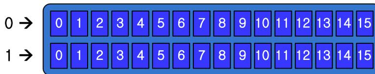
초기에는 커서의 위치를 (0, 0) 으로 잡아 줍니다. 먼저 "TEMP :" 라는 문자를 출력하고 커서를 (7, 0) 으로 옮깁니다. 옮겨진 위치에 온도 센서 값을 표시합니다.
