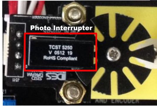
이 포토 인터럽터는 여러분이 전에 배웠던 적외선 센서와 같은 원리입니다. 그런데, 전에 배웠던 적외선 센서가 발광부와 수광부가 같은 방향으로 되어 있어 반사파를 수신하는 대신 이 **포토 인터럽터는 발광부와 수광부가 마주 보고 있어 그 사이를 어떤 물체가 지나가게 되면 수신이 안 되고 물체가 없으면 수신이 되는 것입니다.** 그래서 수신 측에는 다음과 같은 신호가 전달 됩니다.
