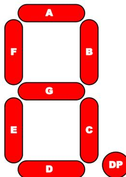
세븐세그먼트는 FND (Flexible Numeric Display) 라고도 합니다. 앞으로는 세븐세그먼트 대신 FND 라는 말을 사용하겠습니다.
