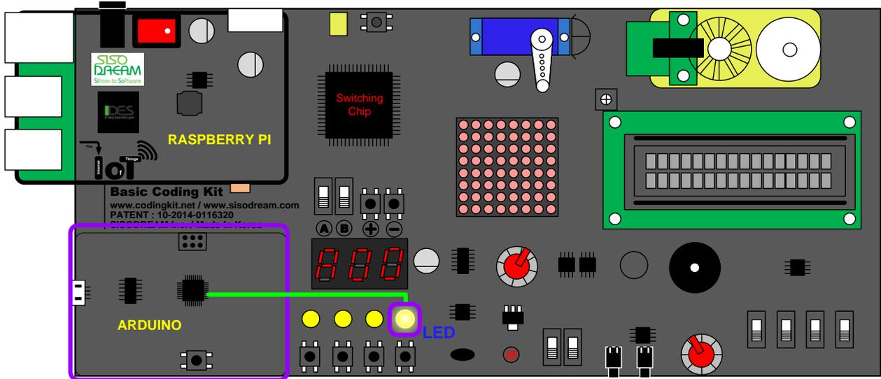
아두이노는 코딩키트의 왼쪽 하단의 보라색 박스 안에 있습니다. 이 아두이노 핀 중 하나에 LED 가 연결되어 있습니다. 이것을 연두색 선으로 표시하였습니다. 좀 더 설명드리면, 코딩키트에서는 아두이노가 아답터에 연결되어 있습니다. 이것은 아두이노가 건전지에 연결되어 있는 것과 같은 것으로 생각하시면 됩니다. 아두이노는 LED 를 켜기 위해서 아답터로부터 받은 1 을 LED 로 보냅니다. 그러면 LED 가 켜지는 것입니다. 그런데, 아두이노로 LED 를 켜기 위해서는 스위치가 건전지에서 받은 1 을 꼬마 전구에 전달하는 것과 같이 아두이노는 아답터에서 받은 1을 LED 에 전달하는 코딩을 해야 합니다. 그 코드는 다음과 같습니다.
