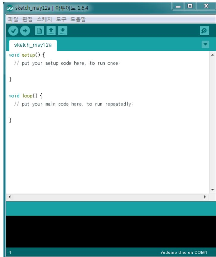
"void setup()" 과 "void loop()" 크게 두 부분으로 나뉘어 있는데요. 편의상 셋업 작업 지시서와 루프 작업 지시서로 이름 붙이겠습니다. 셋업 작업 지시서에 있는 부분은 컴퓨터가 처음 한 번만 수행합니다. 루프 지시서에 있는 부분은 컴퓨터가 계속해서 반복적으로 수행합니다. 즉, 컴퓨터는 셋업 작업 지시서의 내용을 루프 작업 지시서 보다 먼저 처음에 딱 한번만 수행합니다. 그 이후에 루프 작업 지시서의 내용을 계속해서 반복적으로 수행합니다.
