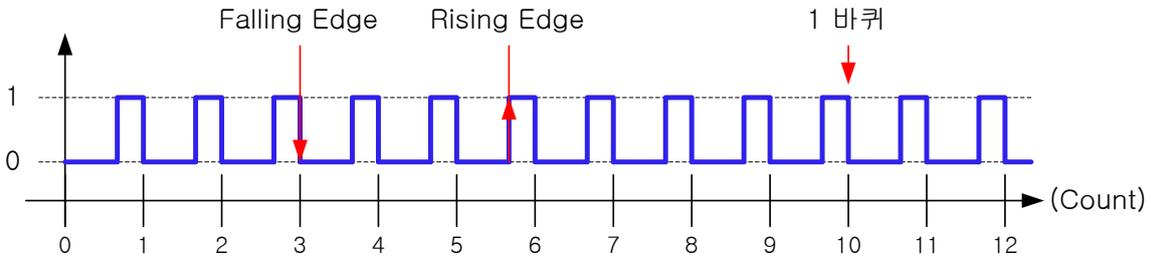
위의 그림에서 신호가 0 으로 떨어진 부분이 센서 사이에 휠의 날개가 들어간 상태이고 1 로 올라간 부분이 센서 사이에 휠의 날개가 없는 상태인 것입니다. 이 휠의 날개가 10 개이기 때문에 센서 수광부에서 신호 값이 0 으로 내려가는 부분을 10 번 카운트하면 DC 모터가 한 바퀴 돌았다는 것을 알 수 있습니다. 여기서 1 로 올라가는 부분을 Rising Edge 라고 합니다. 반대로 0 으로 떨어지는 부분을 Falling Edge 라고 합니다. Rising Edge 든 Falling Edge 든 10 번만 카운트 하면 DC 모터가 한 바퀴 돈 것을 알 수 있습니다.
